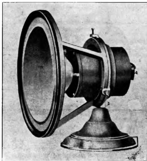
Zij-aanzicht van een electro-dynamischen luidspreker met electro-magneet en opgebouwd uit door de Engelsche firma's Baker's Selhurst Radio vervaardigde onderdeelen.
